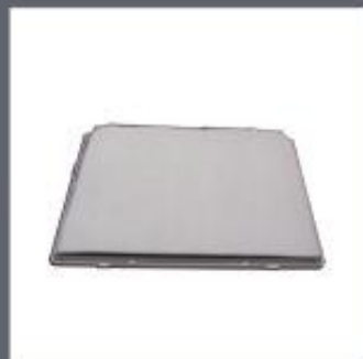
③ 换上新的过滤布 (粗糙一面向下)
