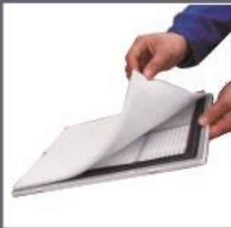
② 拆下旧的过滤布
